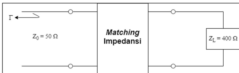
Gambar 1. Dimensi *Matching Impedansi* dengan Transformator *Chebyshev*
