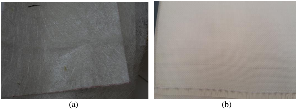
Gambar 1 Serat penguat komposit (a) reinforcing mat 300 glass fiber ; dan (b) Serat aramid woven jenis kevlar 29
