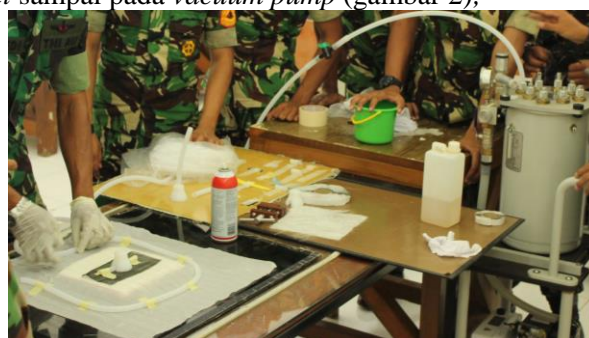
Gambar 2. Persiapan manufaktur komposit metode VARI
