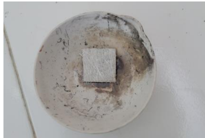
Gambar 4 Spesimen komposit glass /poliester setelah pengujian ignition lost .
