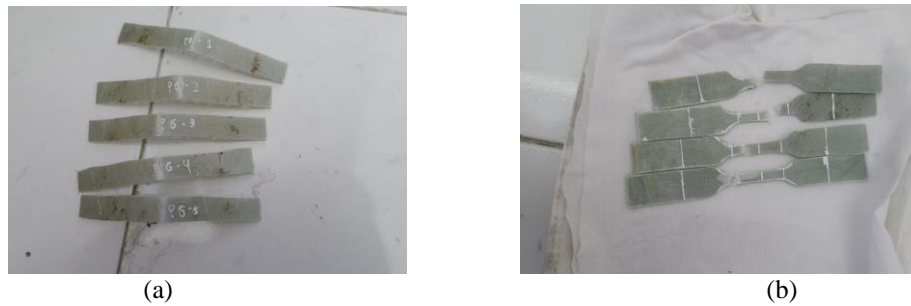
Gambar 3 Spesimen komposit setelah pengujian mekanik : (a) Pengujian Tarik ASTM D638; dan (b) Pengujian Bending ASTM D790
