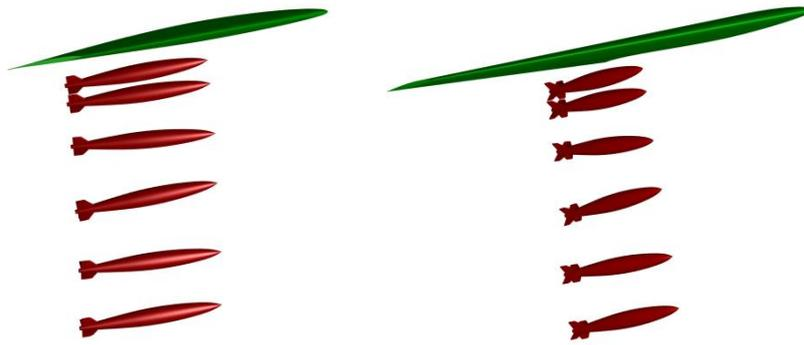
Gambar 7. Posisi Bom Setelah Separasi untuk Kasus *Toss Bombing*
