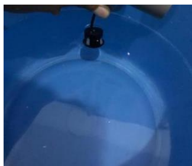
Gambar 8. Pengujian sensor JSN-SR04T masuk ke dalam air
