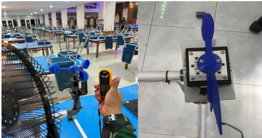
Gambar 7. Pengujian Sensor Anemometer dan Sensor Windvane
