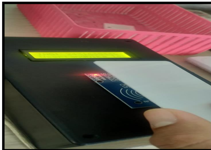
Gambar 5 melakukan scanner terhadap e-KTA menggunakan RFID rc522
