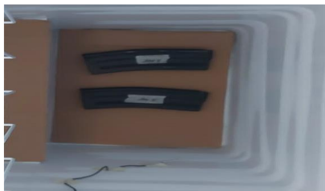
Gambar 4. Proses pendinginan peluru pada freezer dengan suhu dibawah 0°C
