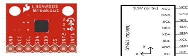
Gambar 1. Accelerometer MPU6050 dan Skema komponen accelerometer MPU6050[5]
