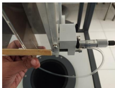
Gambar 7 Pipa Pitot yang terinegrasi dengan Manometer
