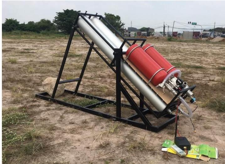
Gambar 8. Desain *Pneumatic Launcher*
